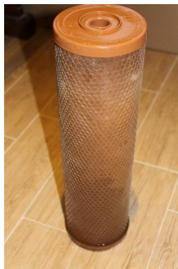
Photo de la rouille (provenant des tuyaux en galvanisé de la société de distribution d'eau) saturant une cartouche non remplacée
