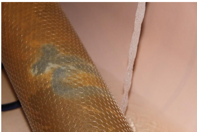
Photo de la rouille (provenant des tuyaux en galvanisé de la société de distribution d'eau) saturant une cartouche non remplacée
