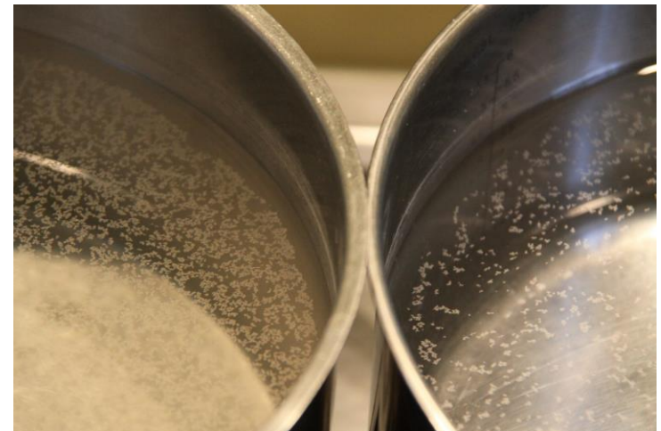
Structure plus compacte et dense à gauche par rapport au tartre épars flottant à la surface de l'eau dynamisée à droite.
