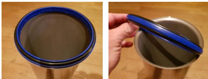
Limpie ambos lados del O-Ring así como el interior de la caja con agua para eliminar todas las impurezas (arena, corrosión, barro, etc.)
